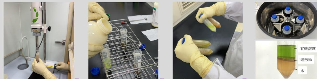
ペースト状にした野菜に有機溶媒と水を加え、小型の超高速ミキサーを使い、農薬を抽出します。
